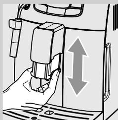
Для выполнения регулировки приподнимите и опустите ручную устройство подачи с помощью пальца, как показано на рисунке.
