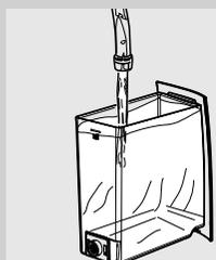
**12** Извлеките бак для воды, ополосните и наполните его свежей водой до указателя уровня MAX. Вставьте его обратно в машину.
