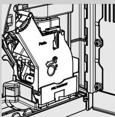
**12** Ополоснув блок приготовления кофе, снова вставьте его в гнездо вплоть до фиксации (см. главу «Еженедельная чистка блока приготовления кофе»). Вставьте контейнер для сбора отходов и контейнер для сбора жидких отходов. Закройте дверцу для обслуживания.
