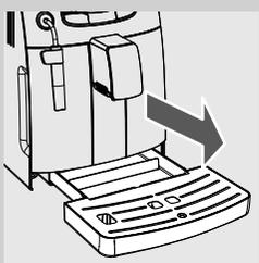
**16** Для очистки поддона для сбора капель поместите внутрь него таблетку для удаления кофейного масла и наполните его на 2/3 горячей водой. Дайте чистящему раствору подействовать в течение приблизительно 30 минут, затем тщательно ополосните поддон.
